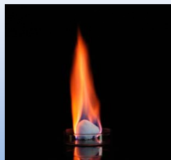
人工のメタンハイドレートを燃焼させた様子
