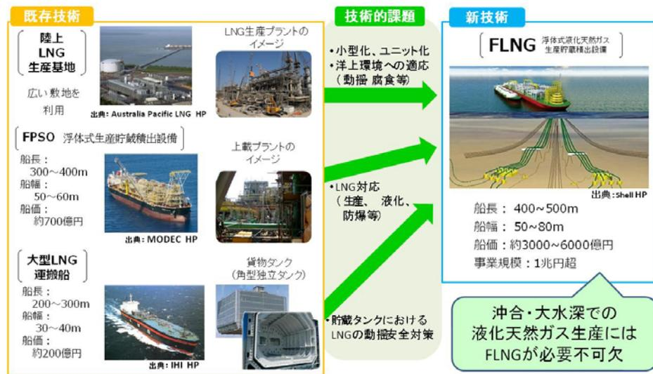
図表 I - 4 - 2 新技術例：FLNG（浮体式液化天然ガス生産貯蔵積出設備）
