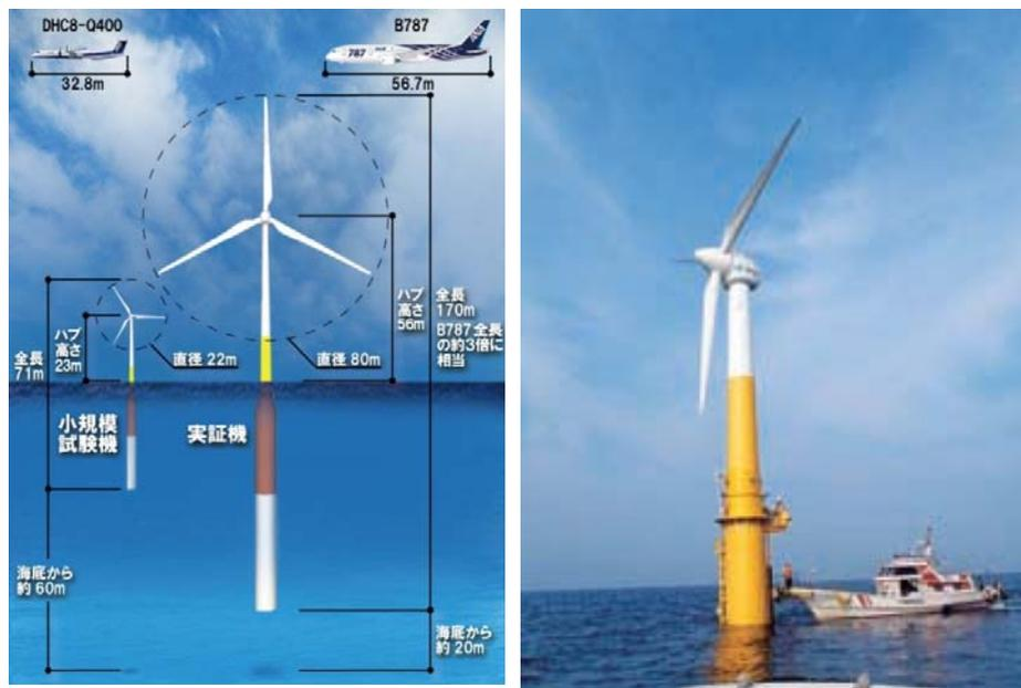
実証機と小規模試験機のサイズの比較
