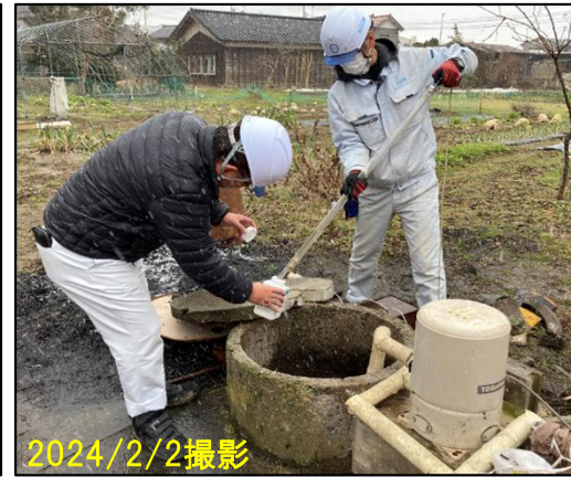
既設井戸水からの採水状況
