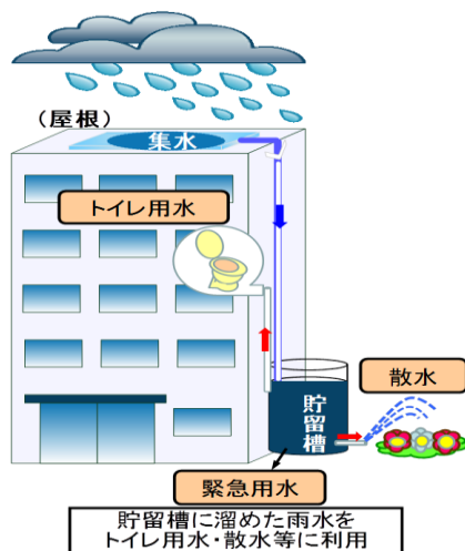
雨水の利用施設の例
