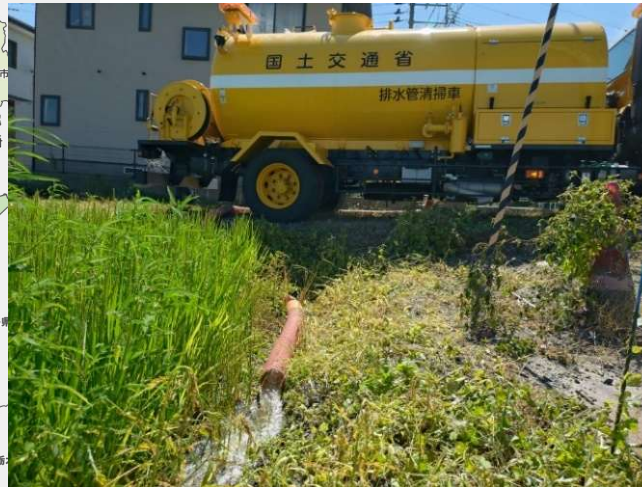
排水管清掃車による田んぼへの給水状況
