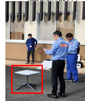
衛星インターネット装置による通信確保 (熊本県上天草市)
