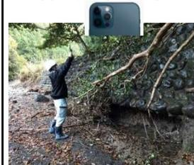
職員によるタブレット端末での点群計測
