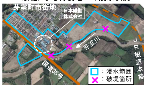
破堤による背後地への浸水状況
