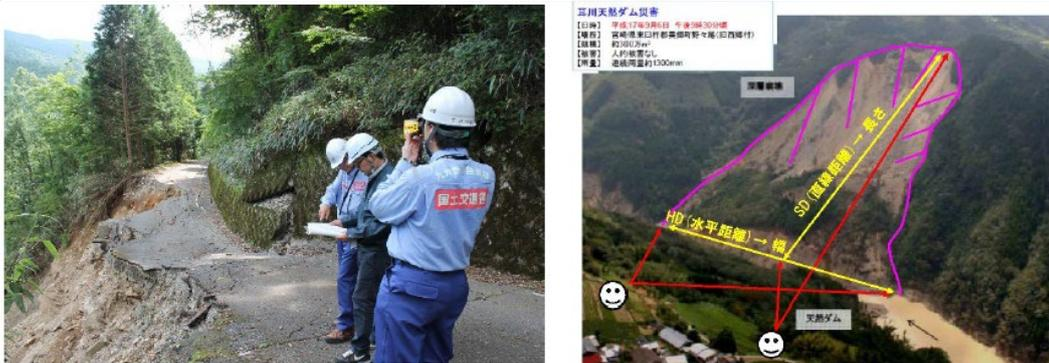
豪雨災害によって斜面崩壊した現場において、危険な箇所に立ち入らずにレーザー距離計を活用し、被災規模を把握した。
