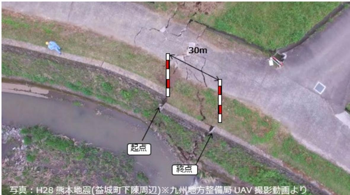
図 3-7 ドローンによる空撮写真で査定設計書の平面図を作成した事例 1
