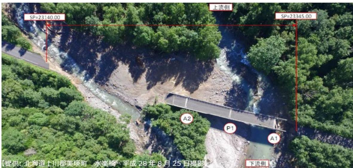
図 3-8 ドローンによる空撮写真で査定設計書の平面図を作成した事例 2
