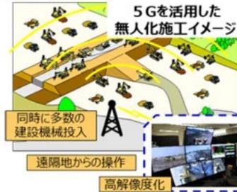
大容量・低遅延・多数同時接続の特性をもつ5Gを活用し、無人化施工の生産性を向上。ポストコロナによる、非接触型・リモート型の働き方への転換。
