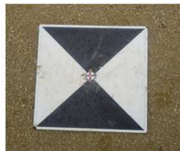
図 3 水平に設置した標定点
