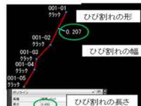
代表ひび割れの計測データ
