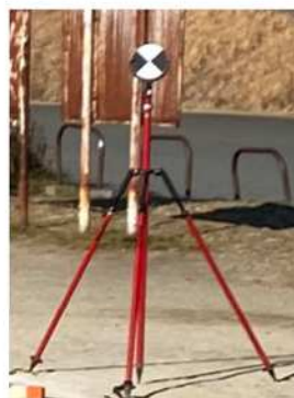
図 2 垂直に設置した標定点
