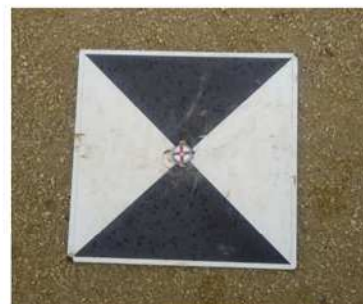
図 3 水平に設置した標定点
