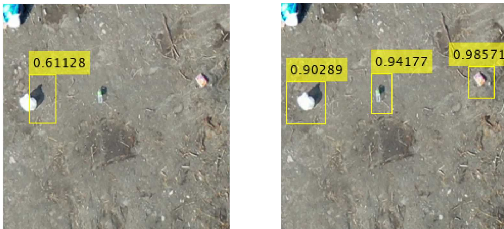
左：少数の空撮データのみで学習した AI，右：空撮画像に地上画像を加えた AI
