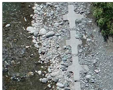
地上解像度：約 1.5cm（対地高度約 50m）
