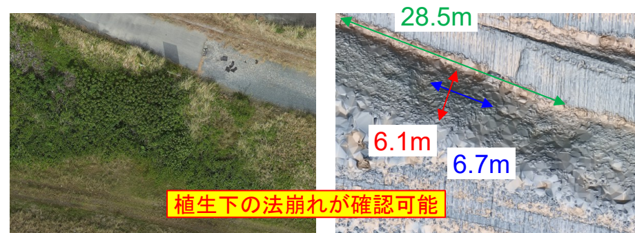
ドローン取得データ (高解像度カメラ: オルソ画像)
