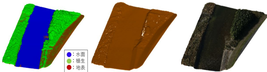
図 1-26 フィルタリング処理
