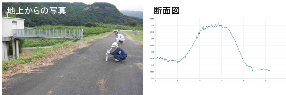
図 1-29 オブリークカメラで取得可能な画像例 (左：地上からの写真、右：取得した点群データより作成した断面図)
