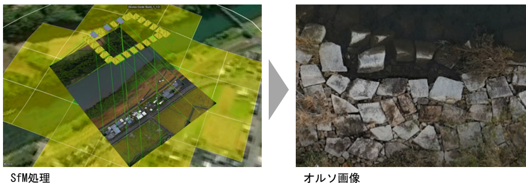
図 1-14 SfM 処理によるオルソ画像作成イメージ
