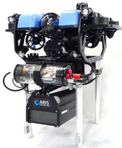
音響カメラ搭載型ROV
