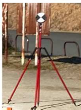
図2 垂直に設置した標定点
