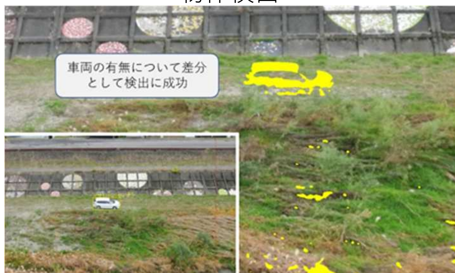
差分による異常検出
