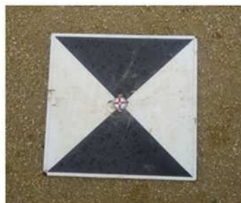
図3 水平に設置した標定点
