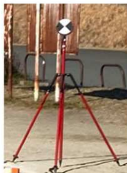
図2 垂直に設置した標定点
