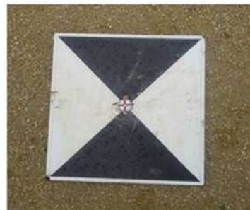
図3 水平に設置した標定点
