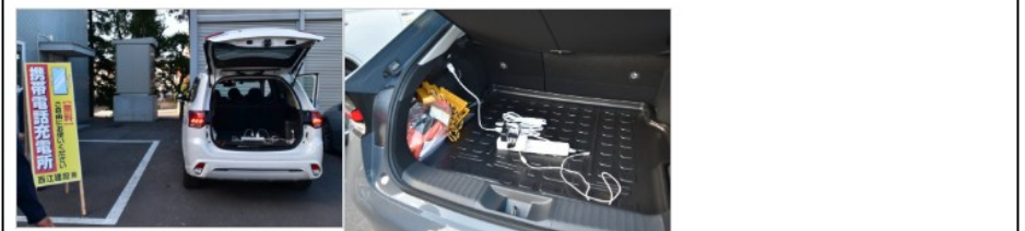
ハイブリッド車を活用した携帯電話充電場所の設置
