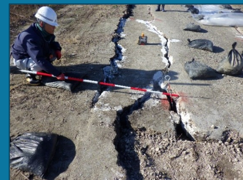
2026,1,6 島根県東部地震に伴い中海堤防に発生した液状化被害調査の状況
