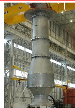
大型ポンプ 例φ1200立軸斜流P
