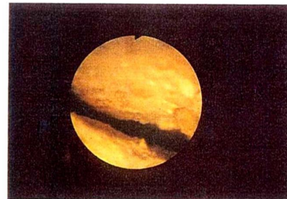
ファイバースコープによる不可視部分点検イメージ （樋管下の空洞調査の事例）
