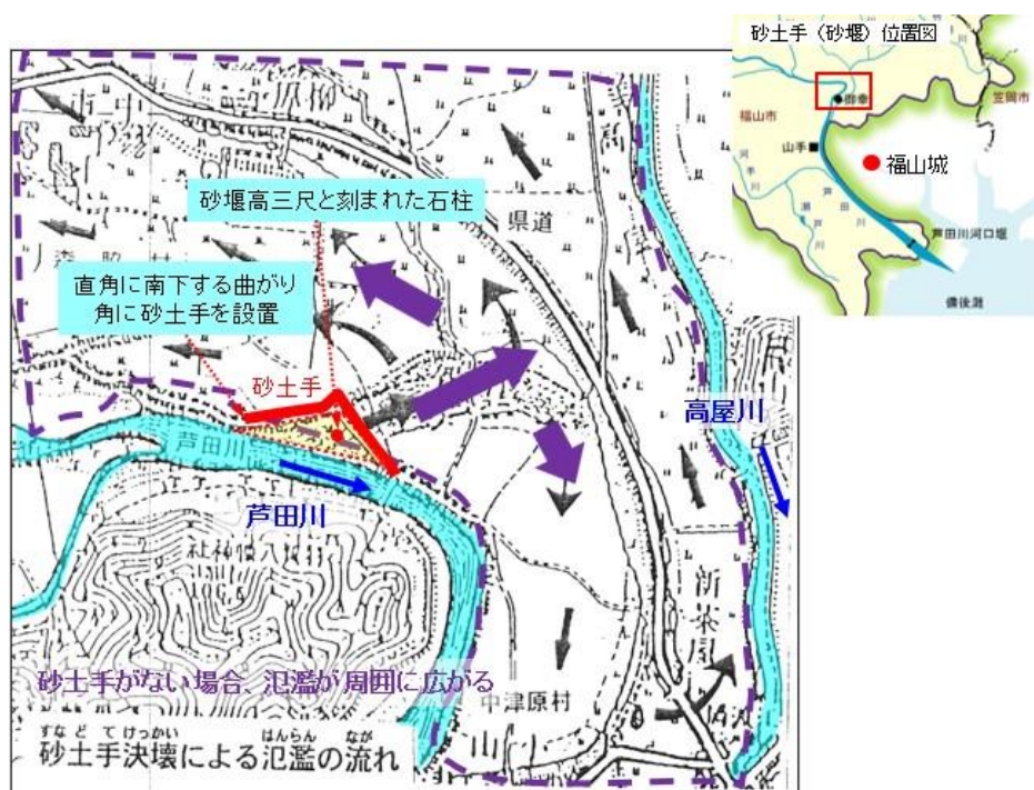
図 4-8 砂土手(砂堰)決壊による氾濫の流れ
