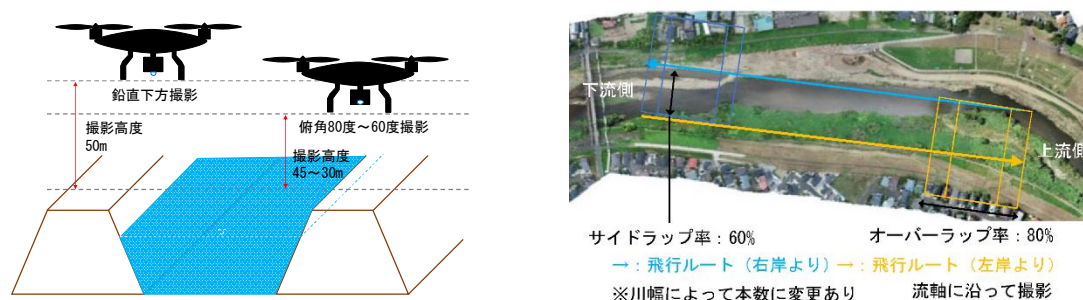
図.技 1-2-3 UAV 写真測量の計測方法
