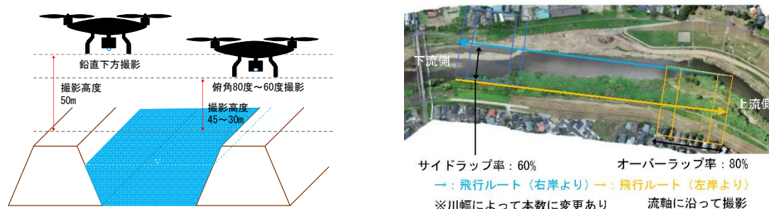
図.技 1-2-4 UAV 写真測量の計測方法
