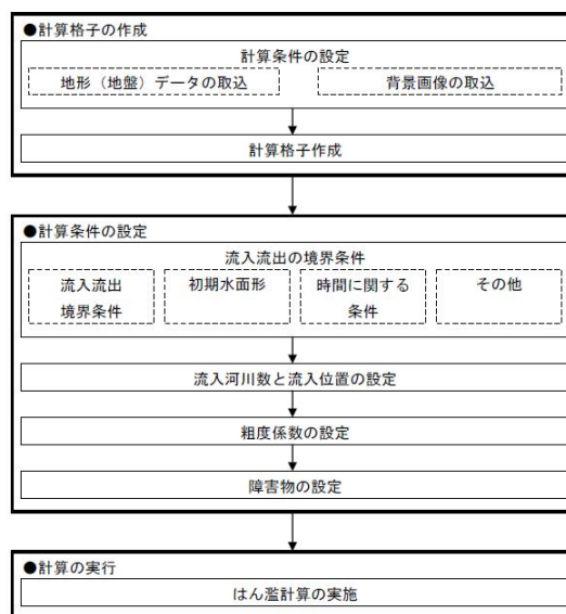
図.技 1-6-3 iRIC による氾濫計算の実施例
