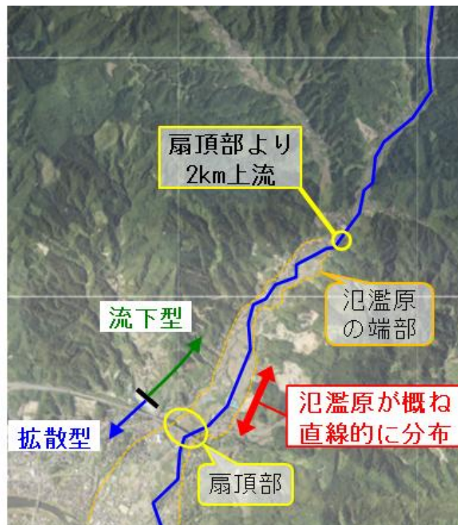
図.技 1-11-2 流下型氾濫において氾濫原が直線的に分布する区間の例
