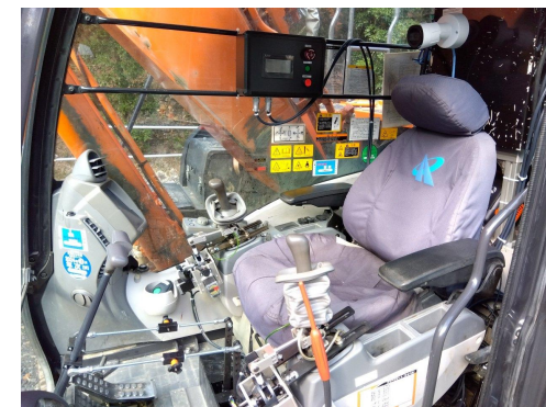
後付け遠隔操縦装置を搭載したバックホウのコックピット
