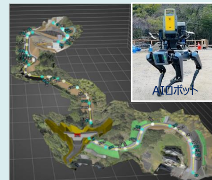
AIロボットを活用した三次元測量
