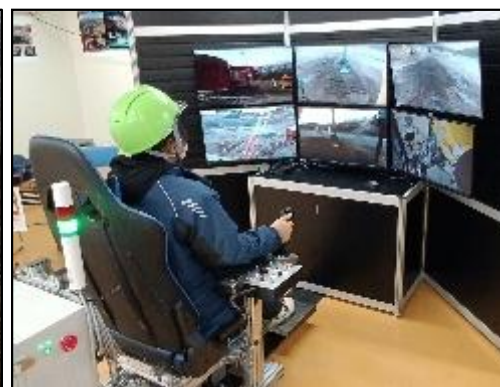
操作室からの遠隔施工実施状況
