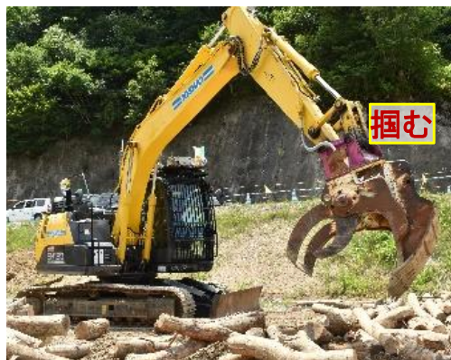
掴み・切断機能付き遠隔操作バックホウ 施工の様子 《遠隔で1台3役(掘る、掴む、切る)を達成》
