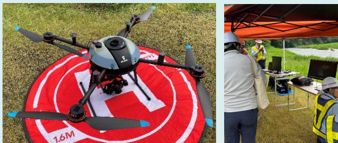
UAVの自律飛行（レベル3.5飛行）を活用した砂防施設点検状況
