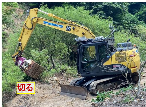
掴み・切断機能付き遠隔操作バックホウ 施工の様子 《遠隔で1台3役(掘る、掴む、切る)を達成》
