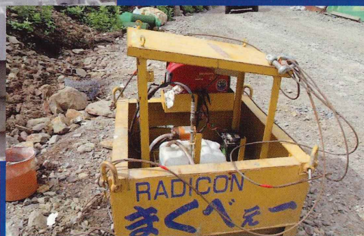
無人化施工用に開発した散布機
