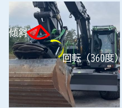
アタッチメントの傾斜（チルト）や回転（ローテーション）が可能
