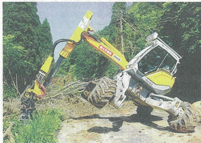
倒木除去、土砂のかき出し1台で
