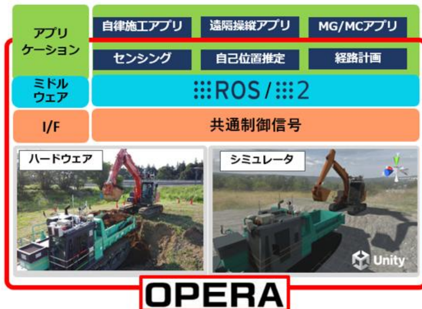
自動施工技術基盤OPERA構成要素
