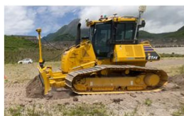
自動化施工ブルドーザの試験施工
