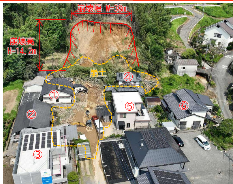
斜面の崩壊状況(頭部滑落崖)
