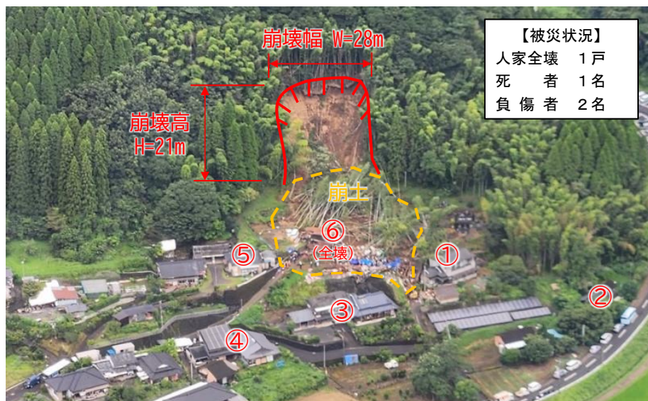
斜面の崩壊状況(頭部滑落崖)
