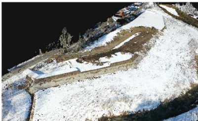
点群データ取得による3Dモデル
