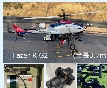
▲UAV搭載機器 LiDAR測量装置（3次元点群データ取得用） 4K動画カメラ 高精細静止画カメラ
