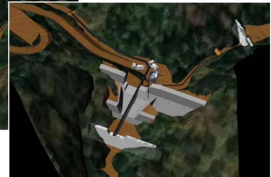
本堤左岸部施工（2次施工）
