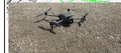
作業確認用UAVによる リアルタイムでの作業状況 把握及び出来形の確認
