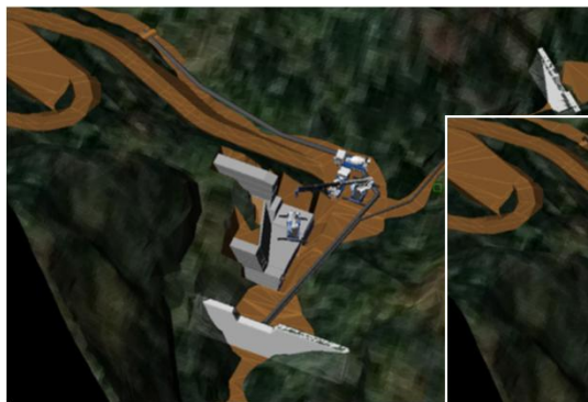
本堤右岸部施工
