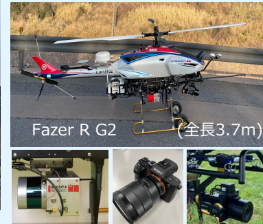
Fazer R G2（全長3.7m） LiDAR測量装置（3次元点群データ取得用） 4K動画カメラ 高精細静止画カメラ ▲UAV搭載機器
