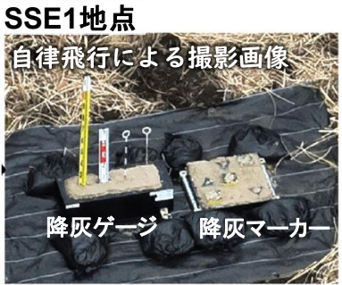
▲ 実証試験結果 降灰マーカーの埋まり具合から1cm～2cmの降灰と判断可能
