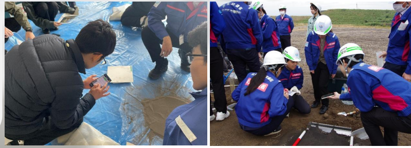
現場ツールを用いた現地調査(左:降灰量調査、右:浸透能調査)
