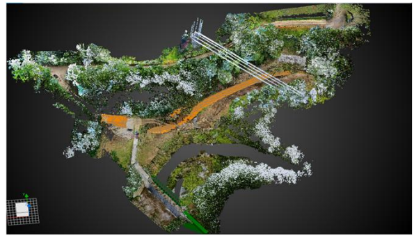
図1 工事用道路モデル
