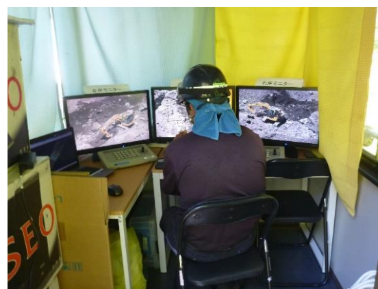
モニターを用いた遠隔操作
