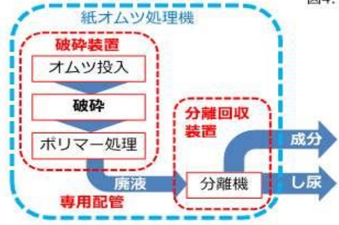
図3.オムツ処理機の構成
