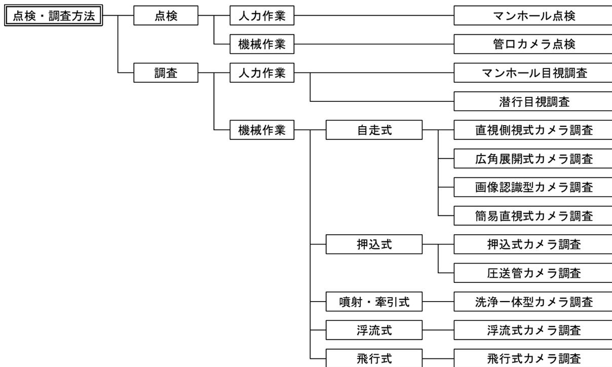
図 2-26 点検・調査方法の体系図の例
