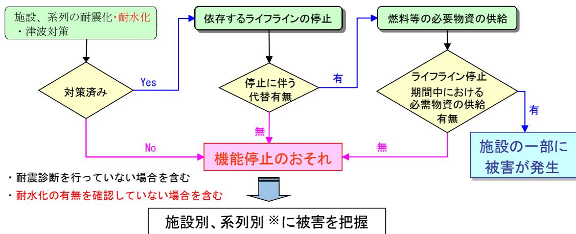
図 2-3 処理場・ポンプ場の被害想定の考え方
