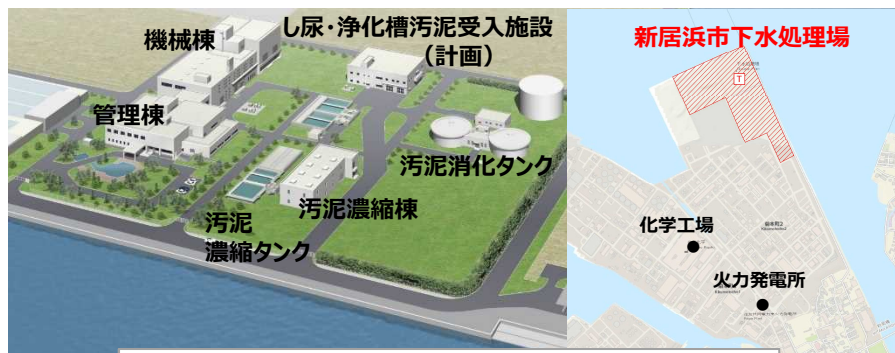
新居浜市下水処理場 汚泥処理施設 概略図
