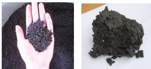
本技術の脱水汚泥(左)と従来脱水汚泥(右)
