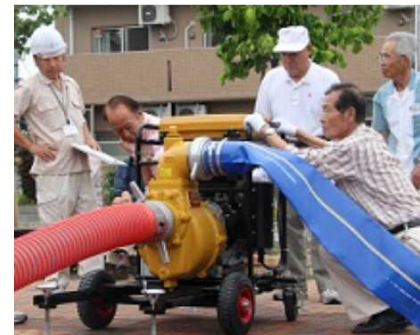
水防用排水ポンプ
