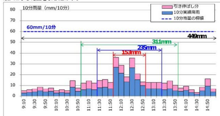
図 2-6 河川流域も含めた計算に用いる想定最大規模降雨
