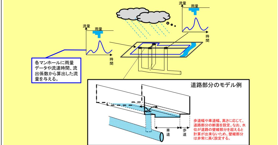
図 3-5 浸水シミュレーション（一次元解析モデルを応用）の概念図
