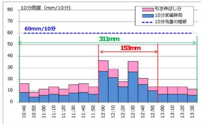
図 2-4 河川流域も含めた計算に用いる想定最大規模降雨
