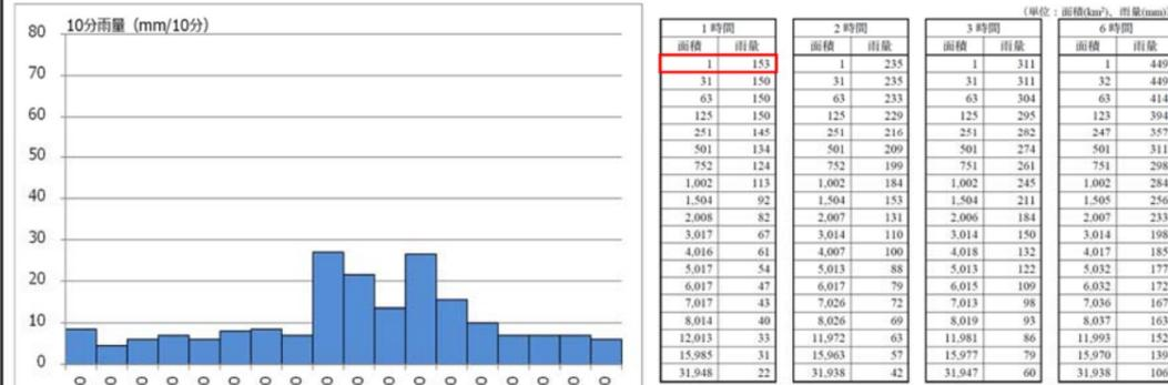
図 1 採用した降雨波形
