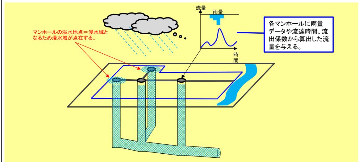
図 3-6 浸水シミュレーション（一次元解析モデル）の概念図
