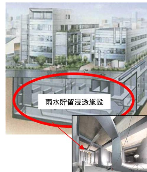
雨水貯留浸透施設の整備イメージ
