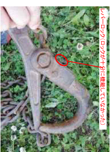
事故発生時に使用していた吊り金具
