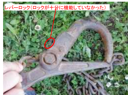
事故発生時に使用していた吊り金具
