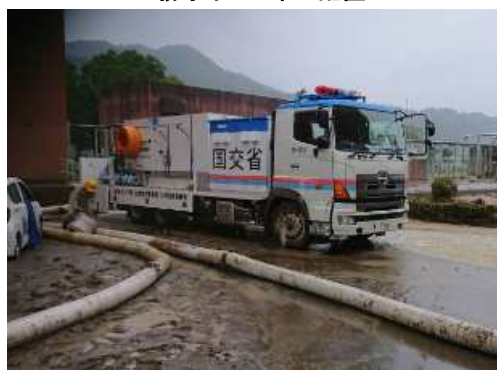
排水ポンプ車により施設内を排水 (人吉市人吉浄水宛)
