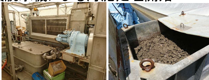
仮設脱水装置による汚泥処理
