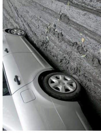
湿潤状態の火山灰 (少量でも車の走行性に影響大) (新燃岳2011年)
