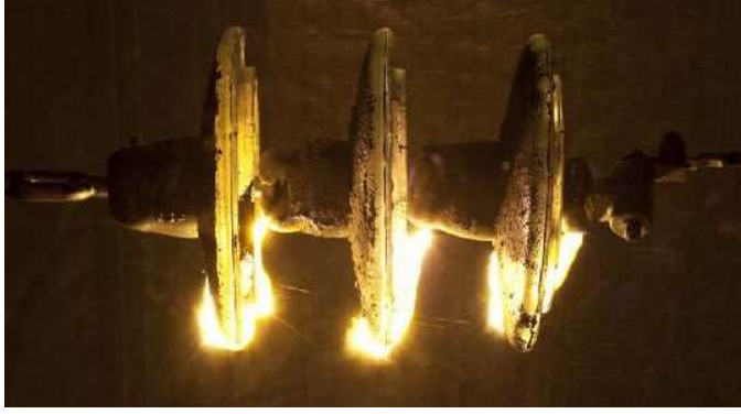
火山灰を用いた碍子の閃絡実験 (Wilson et al, 2011)
