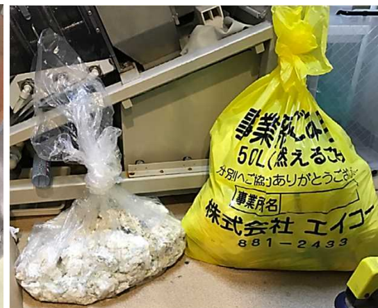
図 処理装置で破砕した使用済紙オムツ (左) と 未処理の使用済紙オムツ (右)
