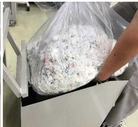
図 処理装置で破砕した使用済紙オムツ (処理装置から取り出す様子)
