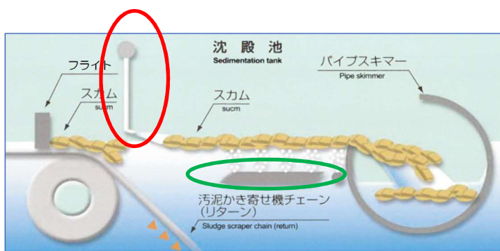
除去装置の仕組み (断面図)
